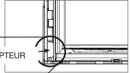
Si vous devez enlever le récepteur, retirez le panneau d'accès gauche du devant de l'appareil. Enlevez les deux vis servant à fixer le récepteur. Tirez le récepteur à travers l'ouverture d'accès puis remplacez.
