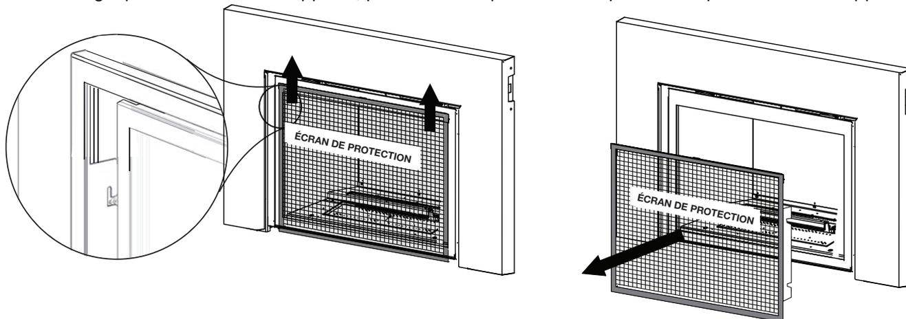
Avant de pouvoir ouvrir ou fermer la porte vitrée, la façade optionnelle doit être retirée. Déverrouillez les loquets supérieurs gauche et droit situés dans le haut de la porte. Penchez légèrement vers l'avant puis soulevez hors des fentes.
