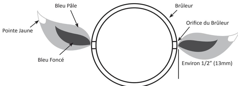
**Brûleur Tube:** Le brûleur est fait d'acier inoxydable 304, mais en raison de la chaleur extrême et d'un environnement corrosif, il se produira une corrosion de surface. Enlevez cette corrosion à l'aide d'une brosse en laiton. Nettoyez les orifices bouchés à l'aide d'un trombone déplié. N'agrandissez surtout pas les orifices du brûleur.
