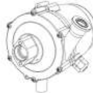
Pompe de recirculation
