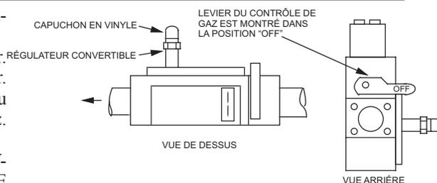
Attention: Conversion doit être faite par un technicien d'entretien qualifié. Les orifices du brûleur principal et la nouvelle étiquette pour le changement des gaz sont fournis dans l'ensemble de conversion qui est attaché au tuyau de gaz.
