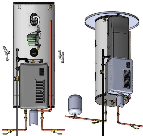
Afin d'accéder aux connexions de gaz, retirez les vis qui fixent l'enclume inférieure à l'appareil.
