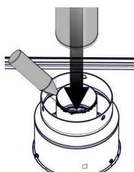
UTILISEZ SILICONE D'HAUTE TEMPÉRATURE POUR SCELLER L'ADAPTATEUR À L'APPAREIL COLLIERS.
