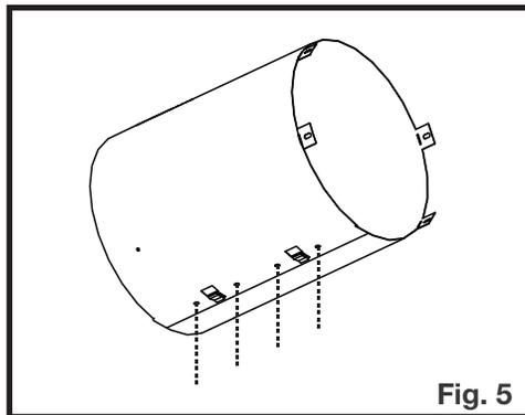
6. Insérez les languettes des douilles d'évent dans les douilles d'espaceur de feuillard. Pliez les languettes de douille d'évacuation et fixez-la à l'entretoise de foyer avec 4 attaches fournies (**Fig. 6**).
