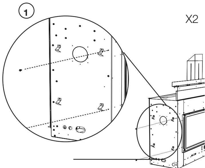
Retirer les deux vis de l'appareil.
