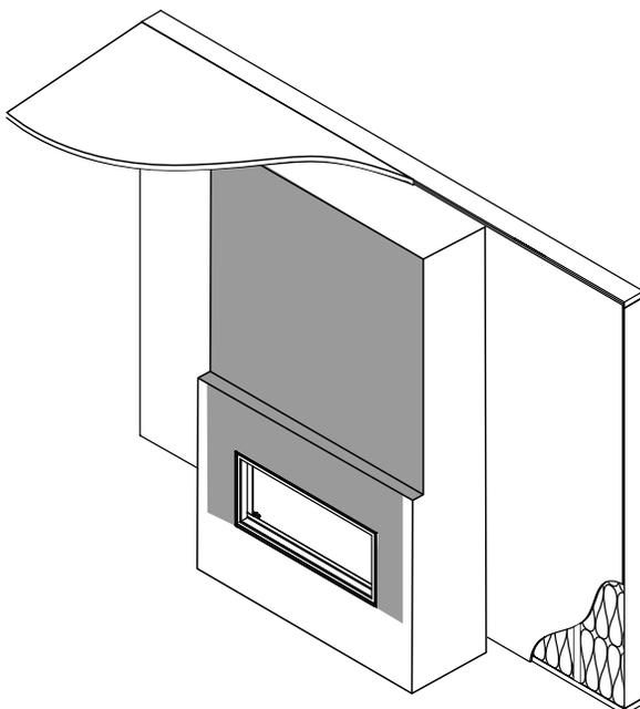
**LA ZONE NON SOMMAIRE DOIT ÊTRE MATÉRI-AUX NON COMBUSTIBLES.** L'installation encastrée **nécessite** un matériau d'évidement pour utiliser un revêtement incombustible en raison de la proximité immédiate de l'évent.
