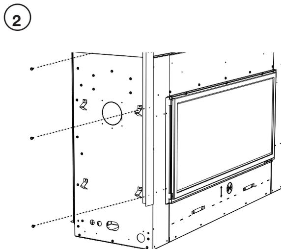
Alignez les pattes de cloutage avec les trous de l'appareil, fixez avec les deux vis d'étape 1.
